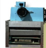
Le prototype du premier appareil photo numérique qui pesait 3,6 kg !
