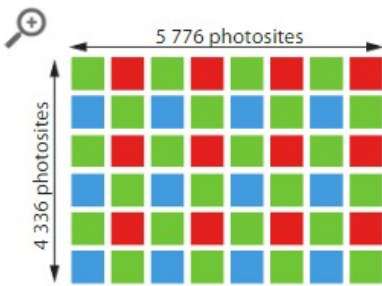
DOC 2 Capteur de 25 millions de photosites
